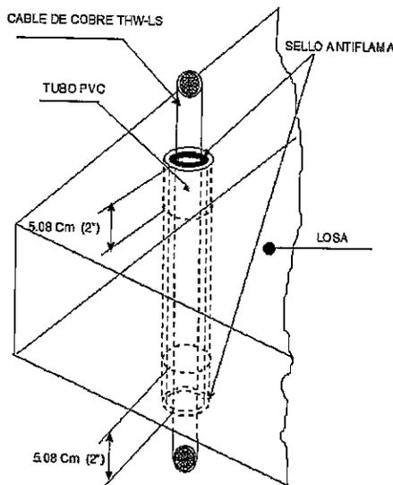
Paso del Cable por Muro Mediante Tubo Conduit de PVC..
